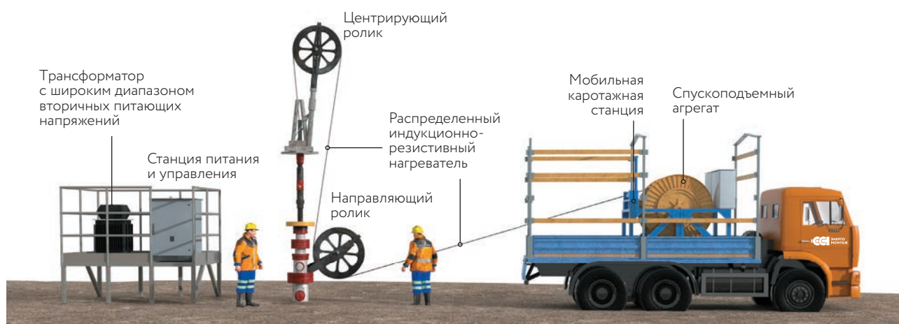
Схема размещения оборудования при монтаже нагревателя системы электрообогрева Stream Tracer™
